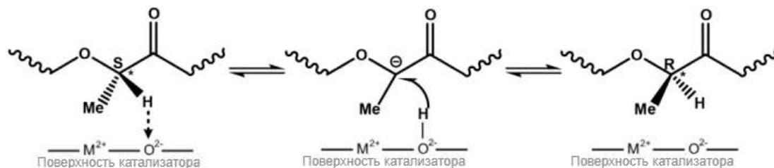
Рис. 2. Предполагаемый механизм рацемизации олигомера на поверхности катализатор
