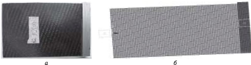
Рис. 1. Композиционный образец (а) и его КЭМ (б)
