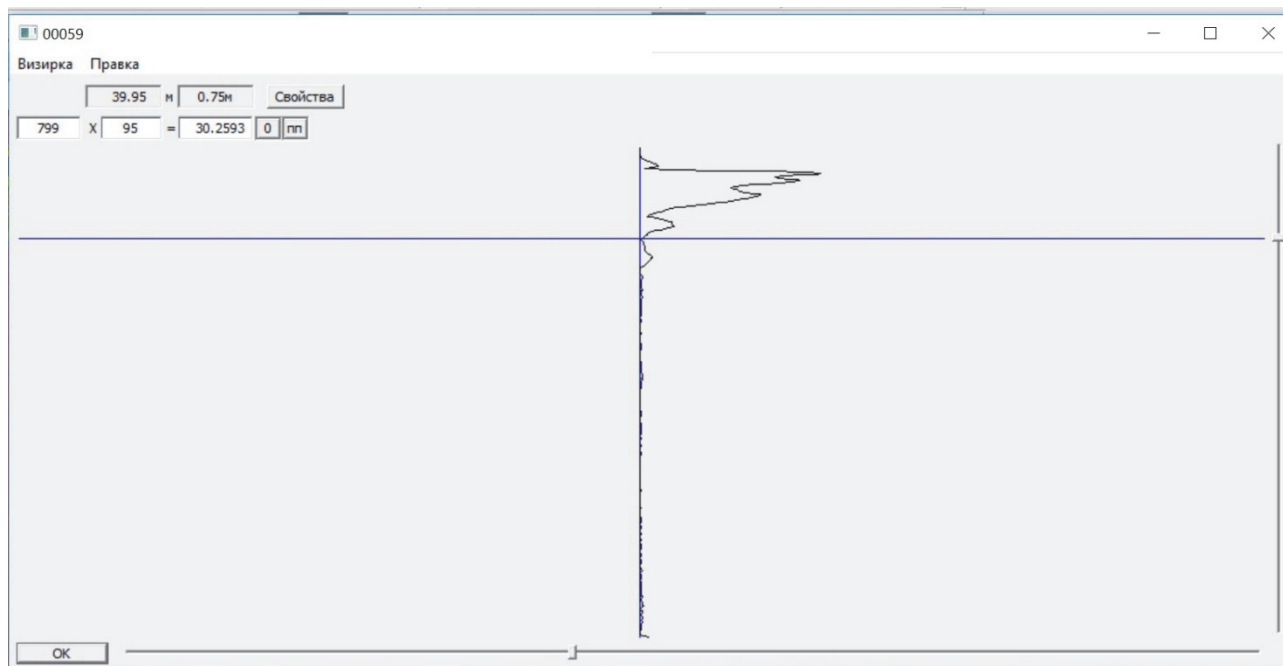
Рис. 1. Осциллограмма георадарной трассы после преобразования Гилберта (окно «визирка» GeoScan 32), горизонтальной линией показана граница торфяной залежи и минерального дна
