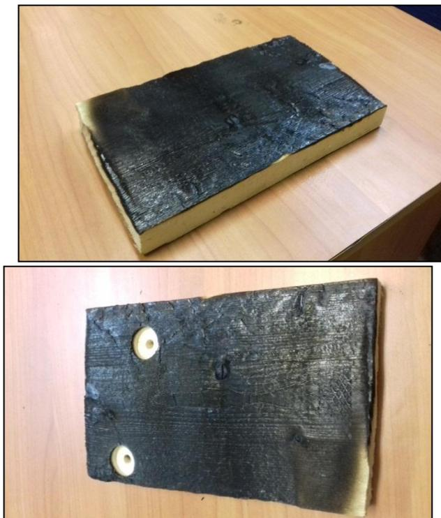
Рис. 1.23. Образцы древесины перед оценкой глубины обугливания
