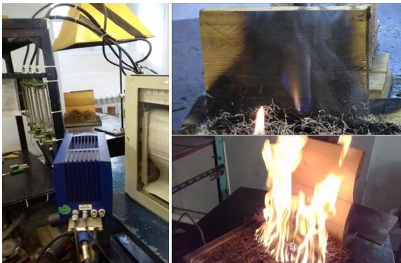
Рис. 1.22. Экспериментальная площадка и образцы древесины во время воздействия очага горения
