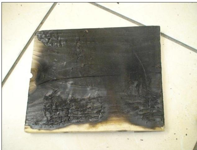
Рис. 1.7. Образец древесины (береза) после проведения эксперимента при скорости ветра 3 м/с
