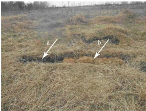
Рис. 2.3. Вид уложенных образцов торфа на экспериментальной площадке: *a* – низинный тип торфа; *b* – вершинный тип торфа
