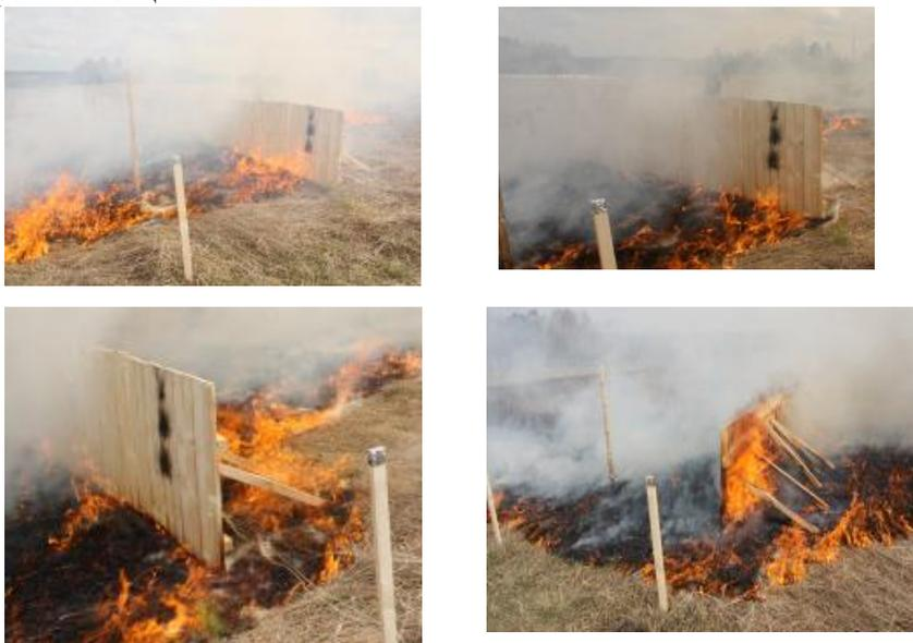
Рис. 2.5. Воздействие фронта степного пожара на деревянные щиты
