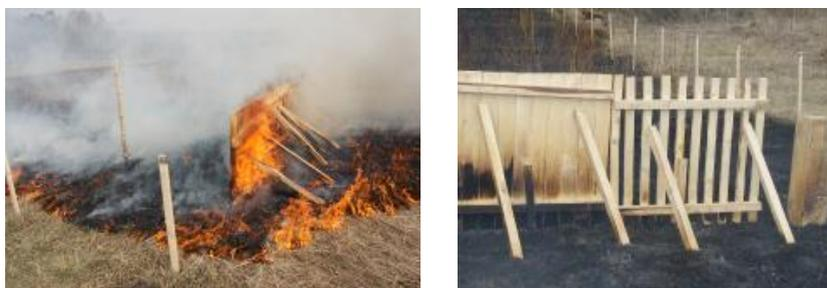
Рис. 2.6. Результаты воздействия степного пожара на деревянные щиты
