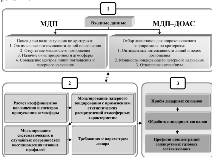
Рис. 1. Схема методики планирования и проведения лидарных МДП–ДОАС измерений
