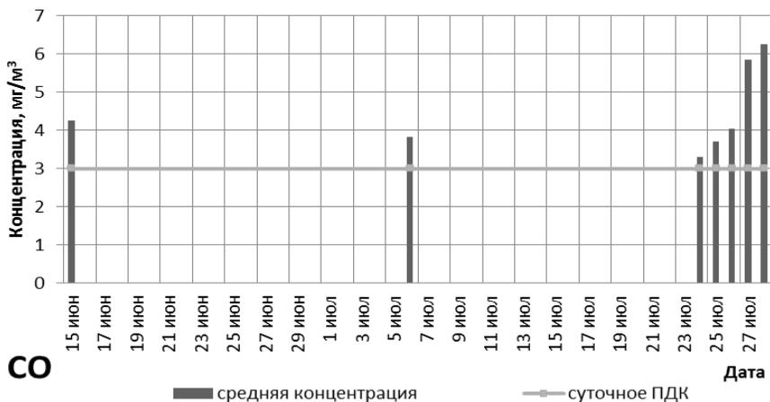
Рисунок 1 – Случаи превышения концентрации оксида углерода (CO) предельно допустимой суточной концентрации
