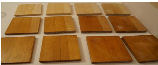
Рис. 1. Образцы для исследования из древесины сосны и березы
