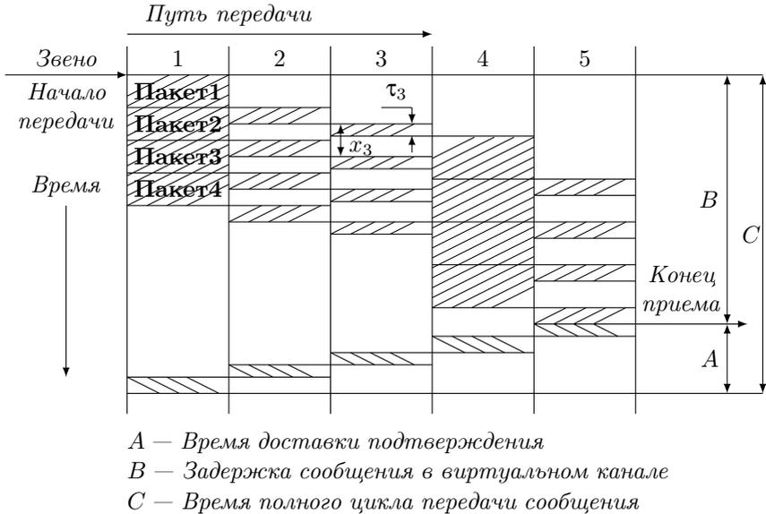
Рис. 5.1. Схема прохождения мультипакетного сообщения по ненагруженному неоднородному виртуальному соединению при  $\tau_4 > \tau_1 > \tau_2 = \tau_5 > \tau_3$
