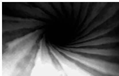
Рис. 1. Нарезной канал ствола, слева – 20 см от казенного среза, справа – 40 см
