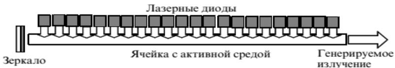
Рис. 3. Принципиальная схема лазера с поперечной оптической накачкой
