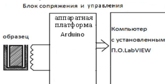
рис.1. Функциональная схема разрабатываемой лабораторной вихретоковой установки
