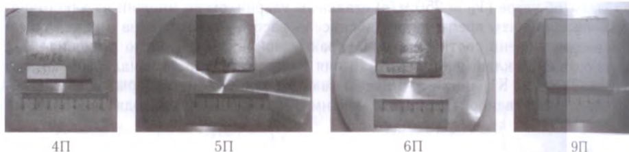
Рис. 1. Образцы защитных пластин из металлокерамика на основе TiB_2 + V_4C и Al_2O_3
