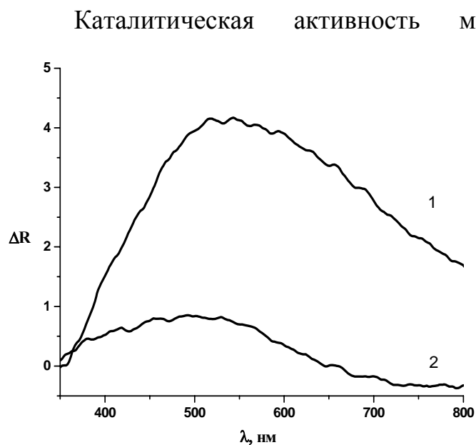
Рис. 8. Результаты вычитания спектров отражения после облучения для материалов: 1 - Cu(Synth.)/F,N-TiO 2 ; 2 - Cu(Impreg.)/F,N-TiO 2
