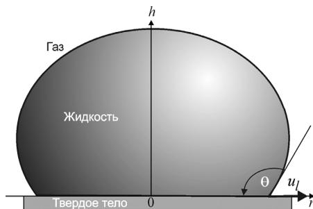
Рис. 3.3. Растекание капли по твердой поверхности
