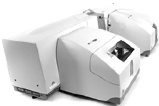
Рис. 14.15. Анализатор размера частиц (гранулометрического состава) «Mastersizer 2000»
