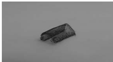
Рис. 3. Плетеная мембрана из сплава никелида титана (с заданной дугообразной формой, повторяющей анатомическую форму альвеолярного отростка собаки)
