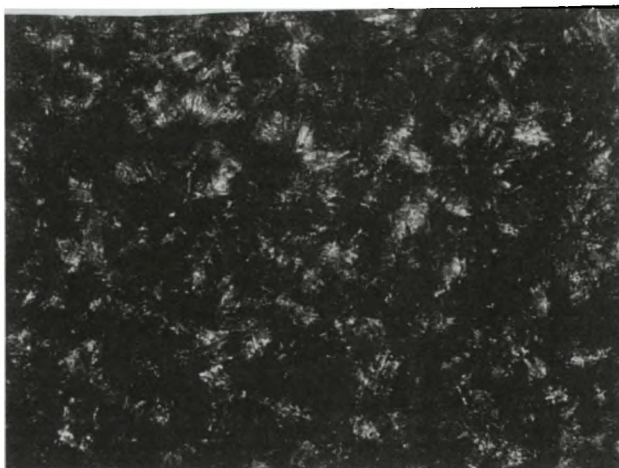
Рисунок 8 – Сферолитовая субмикроструктура петроситалла, получаемая при оптимальных технологических параметрах.
