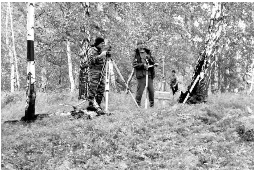
Рис. 1. Топографическая съёмка археологического памятника с использованием полигонометрии и спутниковых 2-частотных геодезических систем
