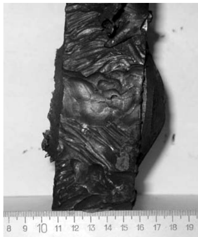
Рис. 4. Бронеплита после соударения со скоростью 2000 м/с (вид сбоку)
