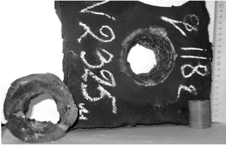
Рис. 6. Вид бронеплиты и откольной тарелки после соударения со скоростью 2325 м/с
