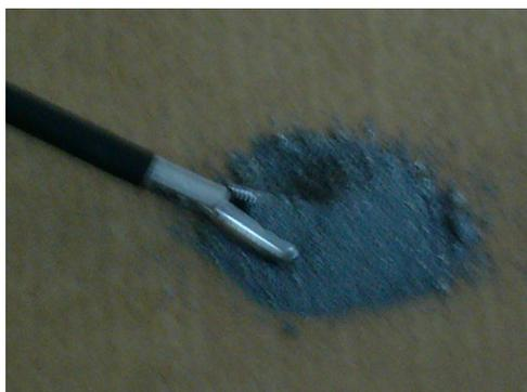
Рис. 2.42. Гранулы порошка пористого никелида титана
