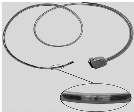
Рис. 3.12. Общий вид оптико-электронного урологического зонда
