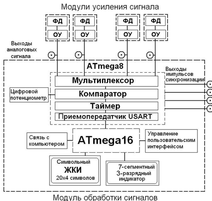
Рис. 3. Блок-схема системы регистрации и обработки сигналов с применением микроконтроллеров
