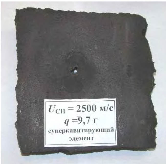
Рис.6. Вид лицевой поверхности бронеплиты после пробития.
