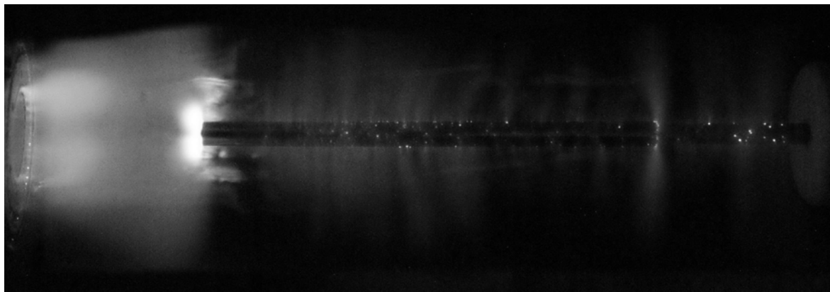
Рис. 7. Фотография свечения разряда, полученная через боковое окно на установке с генератором № 3. Ширина фотографии 35 см
