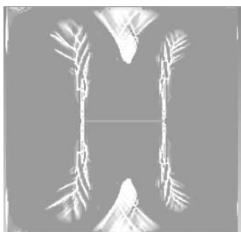
Рис. 11. Расчетная картина квазихрупкого разрушения образца с горизонтальной начальной трещиной при сжатии
