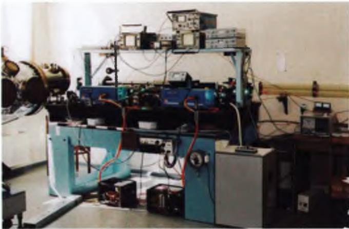
Рис. 7. Непрерывные лазеры на красителе (задающий генератор)
