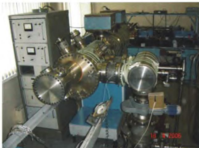
Рис. 3. Вакуумная камера для лазерного разделения изотопов (1)
