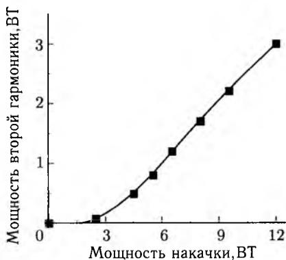
Рис. 2.8. Зависимость мощности второй гармоники от мощности излучения накачки
