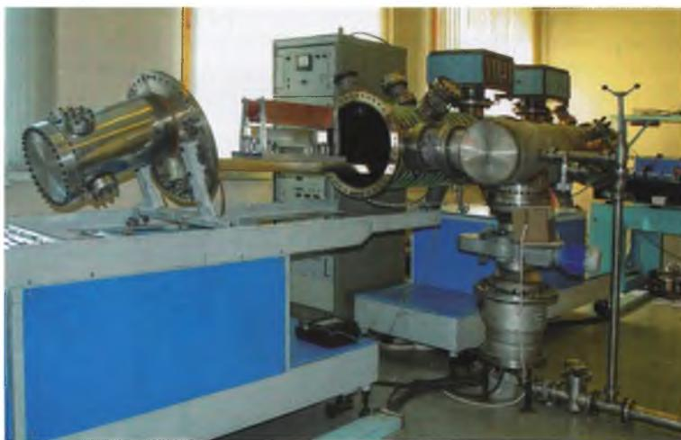
Рис. 4. Вакуумная камера для лазерного разделения изотопов (2)
