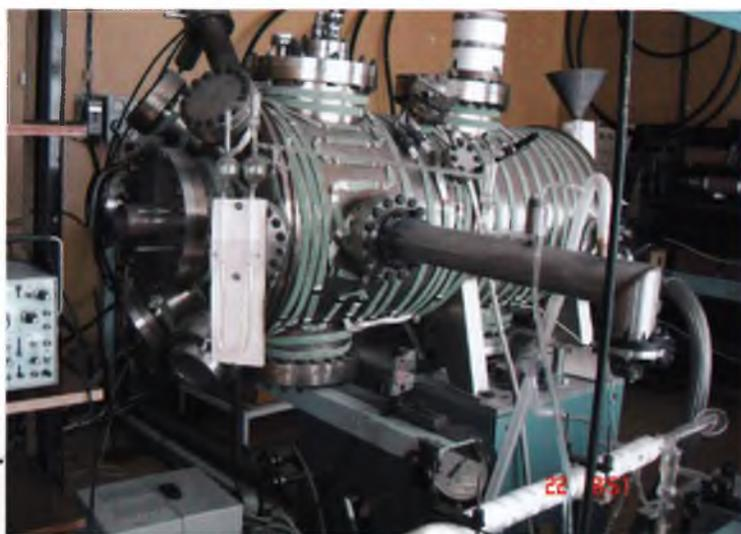
Рис. 5. Вакуумная камера для мелкомасштабного лазерного разделения изотопов
