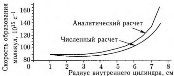
Рис. 5.19. Скорость образования молекул в зависимости от радиуса внутреннего цилиндра
