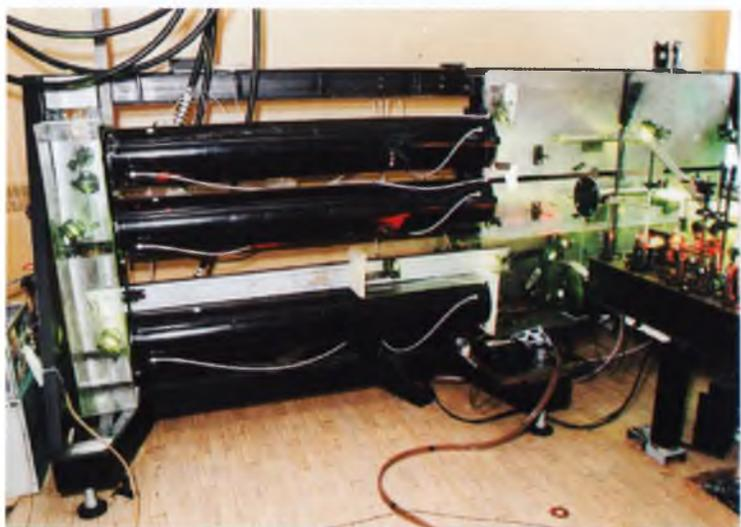
Рис. 6. Комплекс лазеров на парах меди
