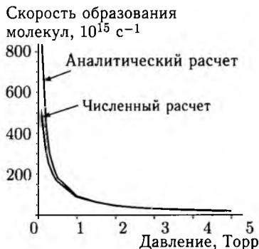
Рис. 5.18. Скорость образования молекул в зависимости от давления
