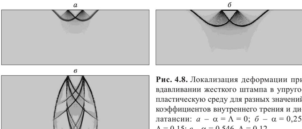
**Рис. 4.8.** Локализация деформации при вдавливании жесткого штампа в упругопластическую среду для разных значений коэффициентов внутреннего трения и дилатансии: *а* –  $\alpha = \Lambda = 0$ ; *б* –  $\alpha = 0,25$ ,  $\Lambda = 0,15$ ; *в* –  $\alpha = 0,546$ ,  $\Lambda = 0,12$ .
