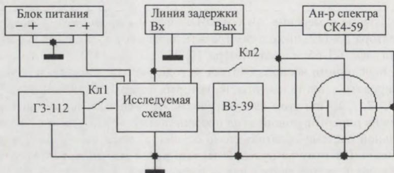
Рис.14 Схема наблюдения запоминания частоты, формы и спектра регулярных колебаний, хаотических колебаний, их фазовых портретов
