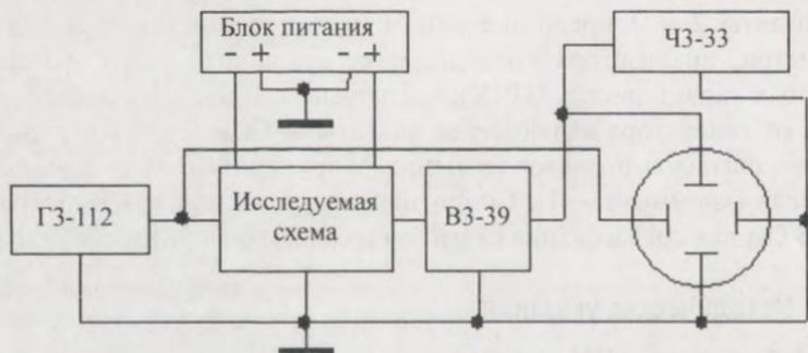
Рис. 13 Схема установки для измерения АЧХ и ФЧХ усилителя
