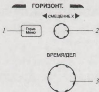
Рис. 8. Панель канала горизонтального отклонения
