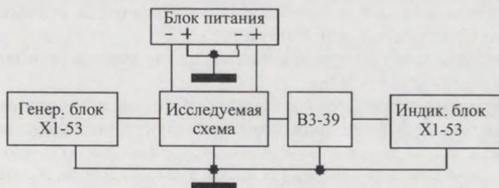
Рис. 12. Схема наблюдения амплитудно-частотных характеристик усилителя
