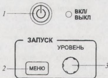
Рис. 9. Панель включения питания и синхронизации
