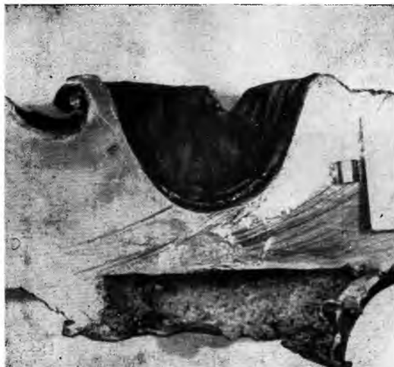
Рис. 5. Скорость удара 5100 м/сек, плита из свинца толщиной 41,5 мм, ударник стальной, l_0=d_0=5 мм
