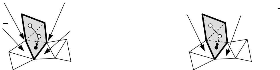
Рис. 87. Вычисление эвристик во взвешенном SGI-алгоритме: а – количество соседей двух узлов текущего треугольника; б – проверка необходимости использования команды swar
