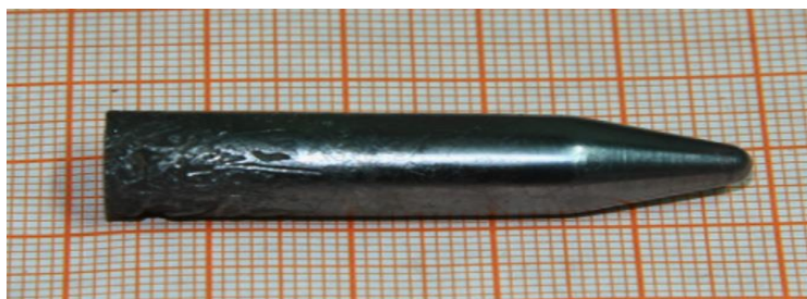
Рисунок 1.11 - Монокристалл \text{CdSiP}_2 выращенный вертикальным методом Бриджмена [8]
