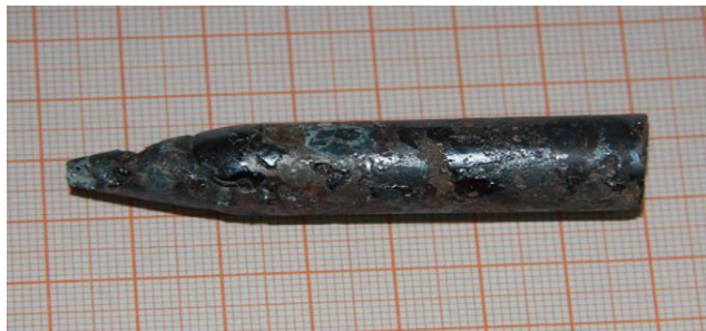
Рисунок 1.10 - Поликристаллический \text{CdSiP}_2 , синтезированный в однозонной печи [8]
