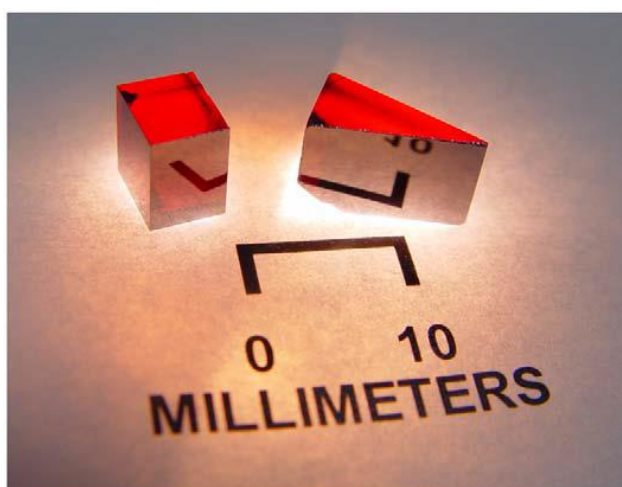
Рисунок 1.16 - Фотография ориентированных и обработанных монокристаллических образцов CdSiP 2 , использованных для измерения свойств материала [9]
