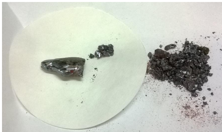
Рисунок 3.2 – Синтезированный поликристаллический \text{CdSiP}_2 [15]
