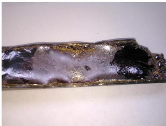
Рисунок 3.10 – Фотография полученного методом направленного охлаждения \text{CdSiP}_2 . Видны остатки стенок кварцевой лодочки
