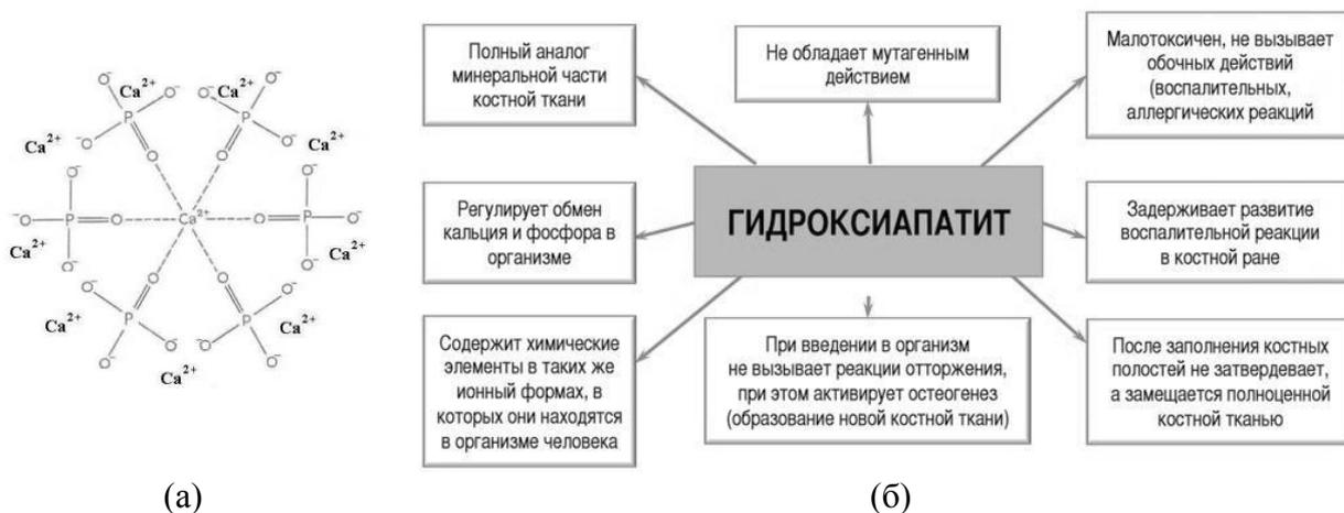
Рисунок 1.5 – Структура гидроксиапатита (а), свойства ГА (б)
