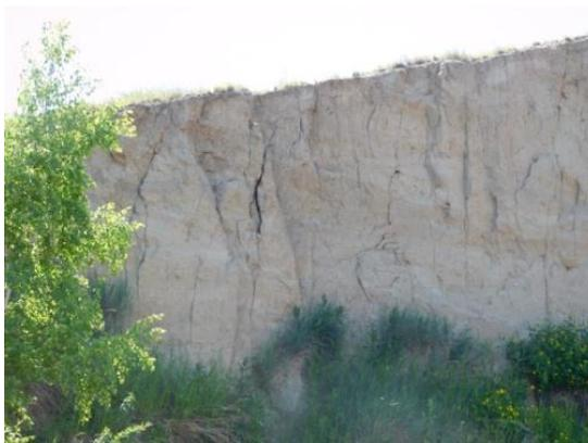
Рисунок 3 - Продольные трещины отрыва [фото автора]
