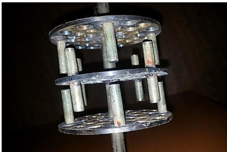
Рис. 2.2 Устройство для смешивания жидкостей и порошков с жидкостями
