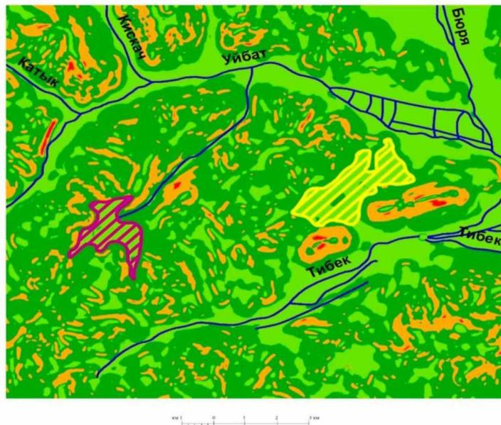
Рисунок 4 – Схема пространственного распределения углов наклона современного рельефа в междуречье Уйбат и Тибек (построена автором)
