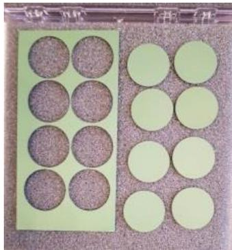
Рисунок 2.1 – Внешний вид полуячеек ТОТЭ анод–поддерживающей конструкции с двухслойным YSZ|GDC электролитом.
