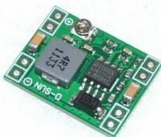
Рисунок 18 – Понижающий преобразователь напряжения
