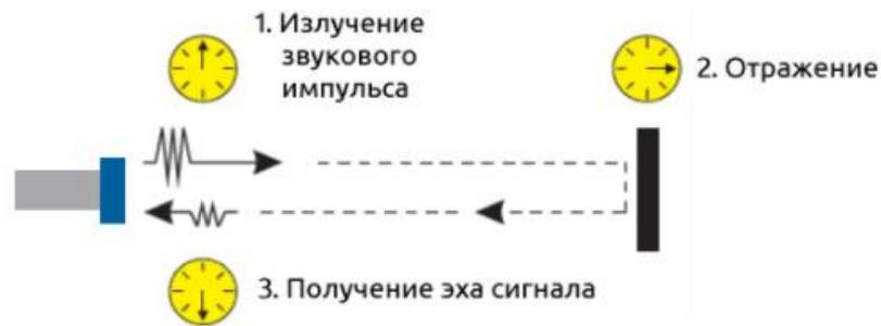
Рисунок 5 – Принцип действия ультразвукового датчика
