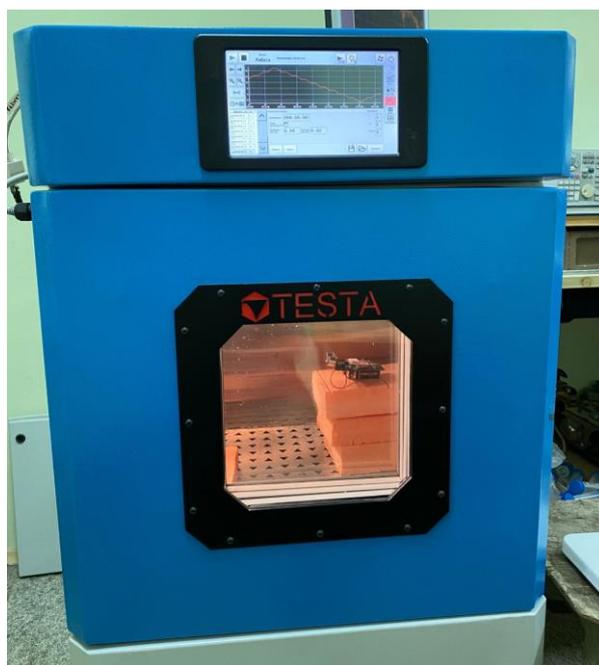
Рисунок 24 – Тестируемый образец в термокамере
