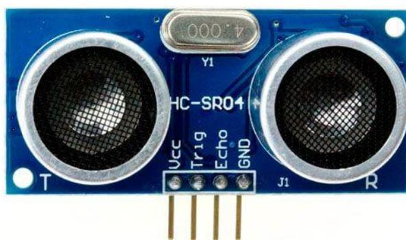
Рисунок 16 – Ультразвуковой датчик HC-SR04
