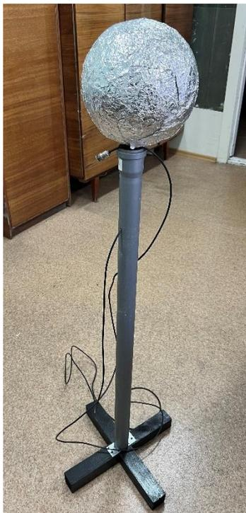
Рисунок 18 – Готовый образец сферической антенны
