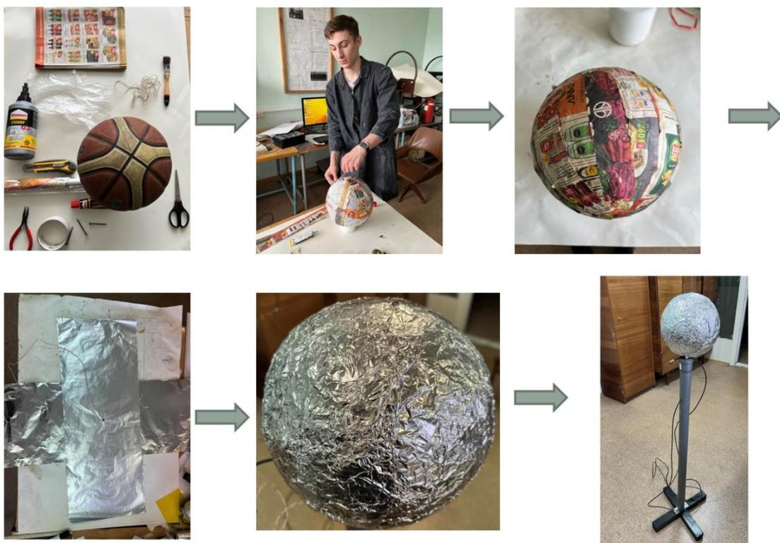
Рисунок 15 – Основные этапы изготовления сферической антенны М. Жердецких
