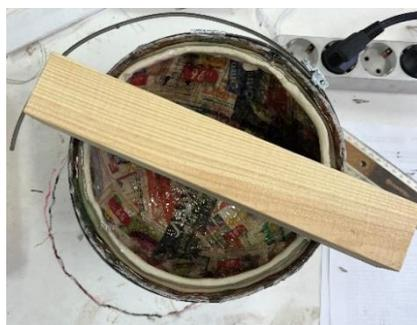
Рисунок 17 – Корректировка поверхности сферы (устранение эллиптичности)
