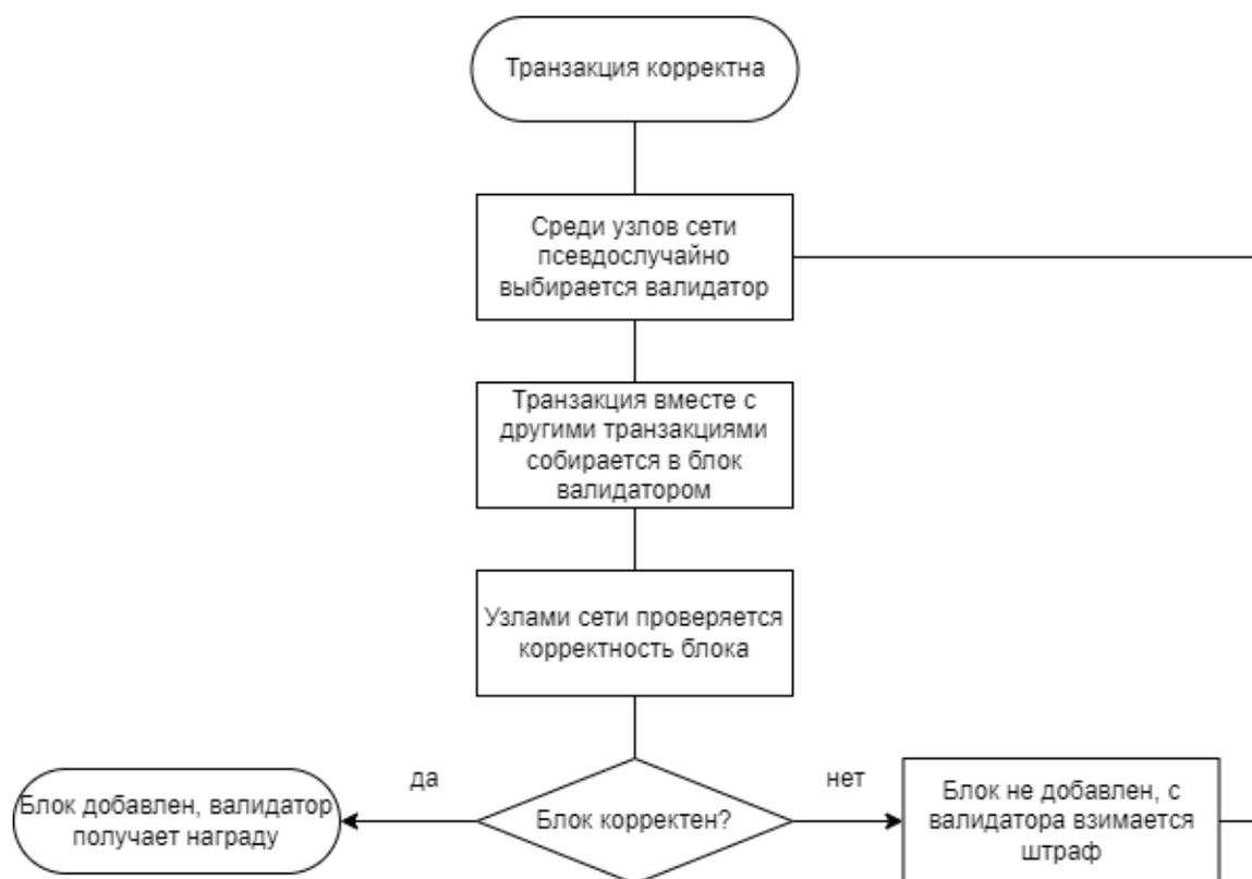
Рисунок 7. Блок-схема добавления транзакции в блокчейн при алгоритме консенсуса PoS.
