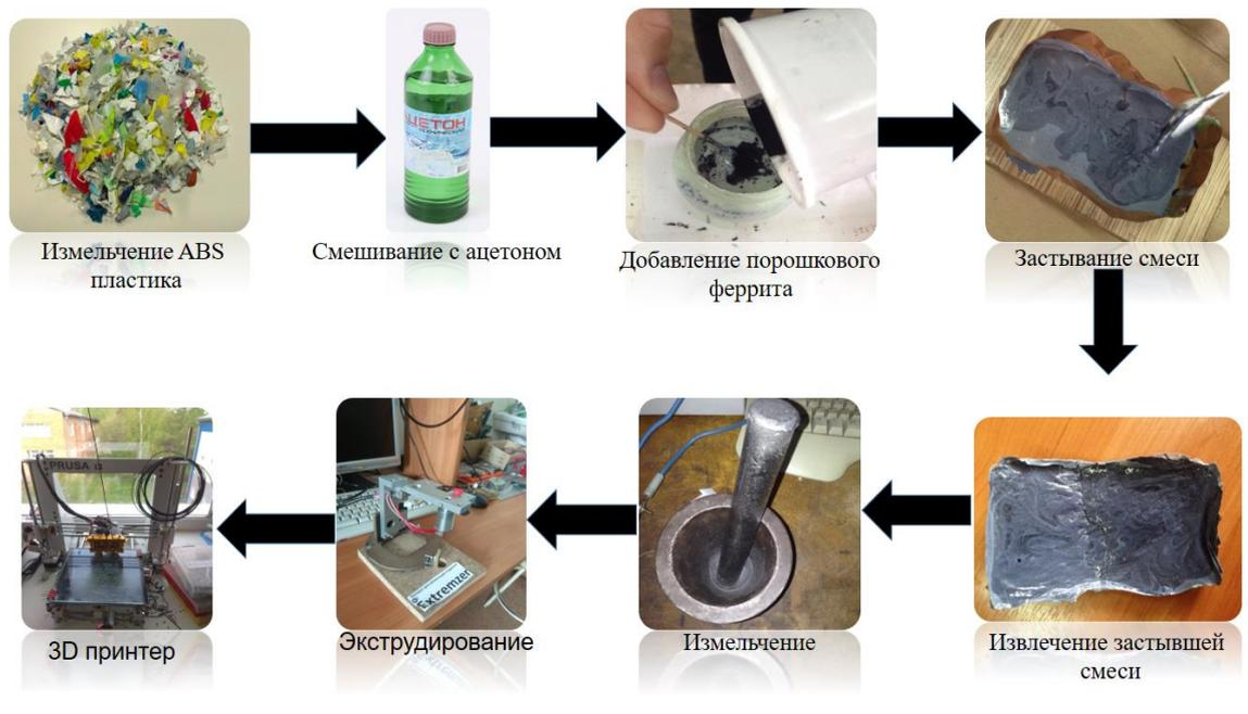
Рисунок 11 – Этапы изготовления образцов для 3D принтера
