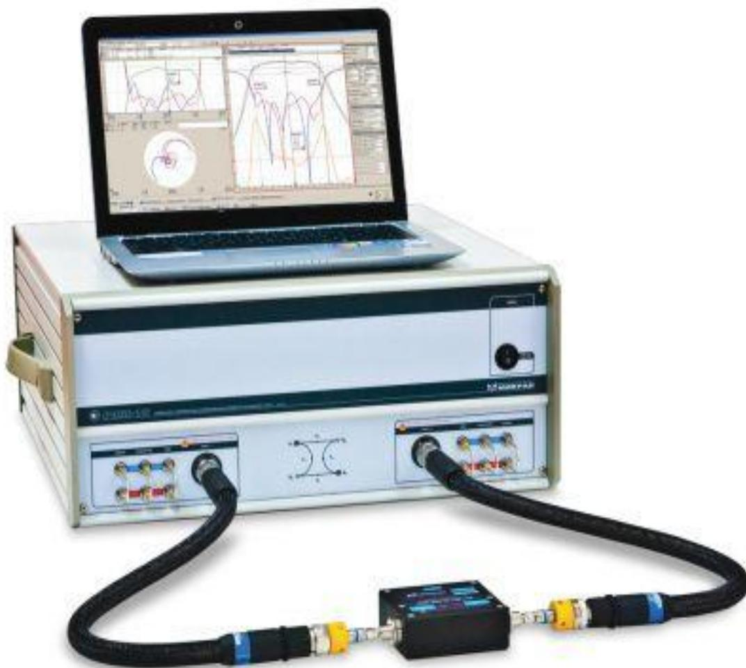
Рисунок 9 – Внешний вид векторного анализатора цепей Р4М-18 [9]
