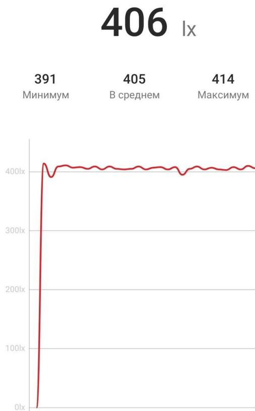
Рисунок 53 – Измерение уровня освещенности
