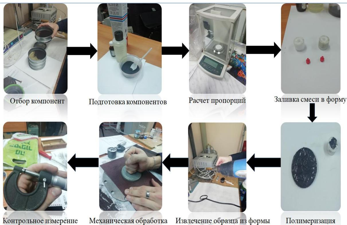
Рисунок 10 – Этапы изготовления образцов
