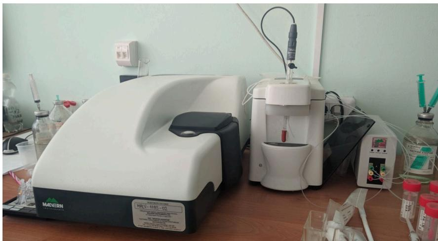
Рисунок 28 — Прибор для измерения дзета потенциала Malvern Zetasizer Nano-ZS
