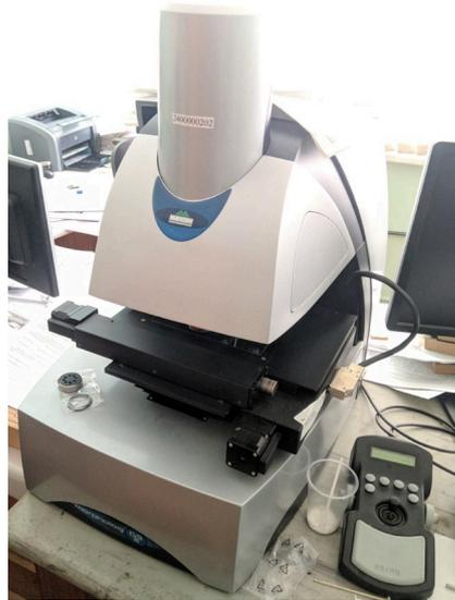
Рисунок 10 — Оптический микроскоп Morphologi G3S
