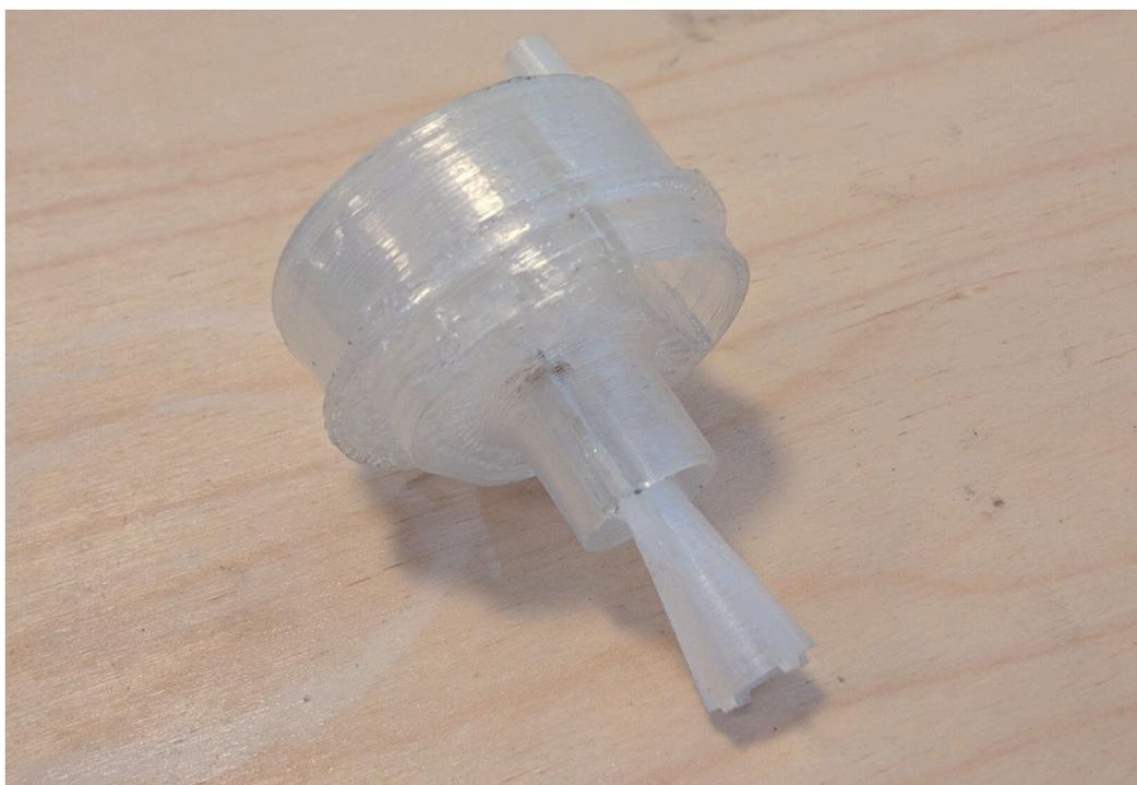
Рисунок 7 — Модифицированная крышка распылительного устройства
