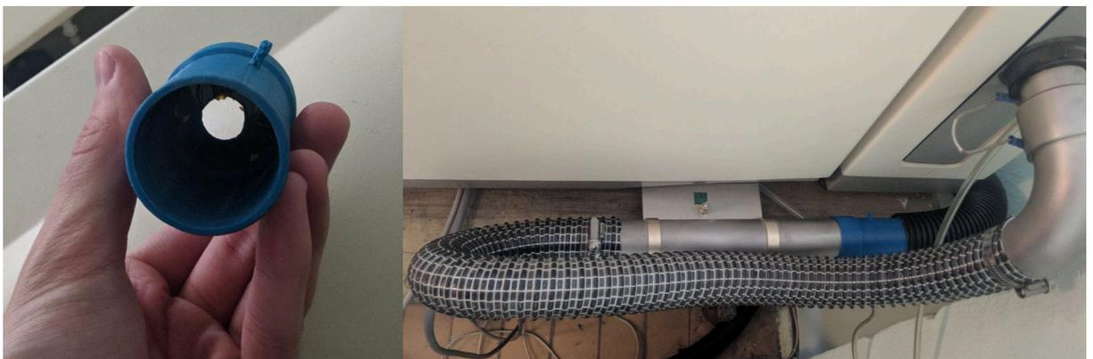
Рисунок 11 — Вакуумное устройство анализатора частиц
