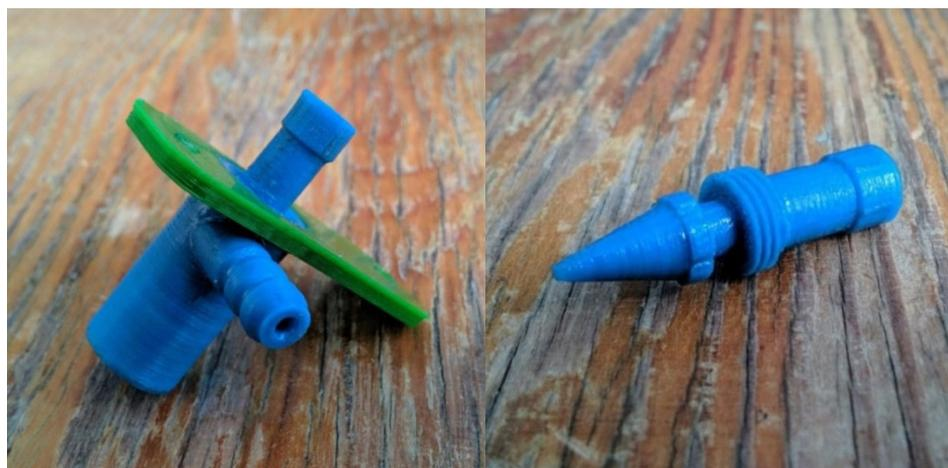
Рисунок 36 — Напечатанное на FDM 3D принтере выходное сопло
