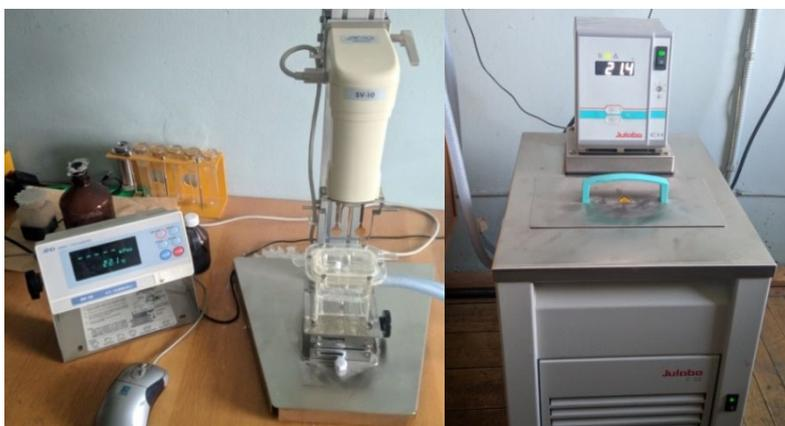
Рисунок 23 — Вязкозиметр AND SV-10 и термостат Julabo
