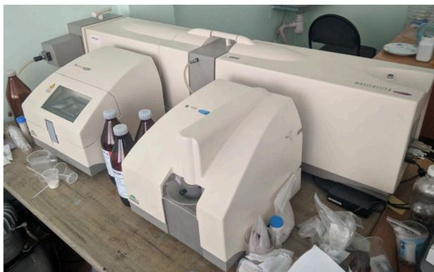
Рисунок 9 — Анализатор размера частиц Mastersizer 2000
