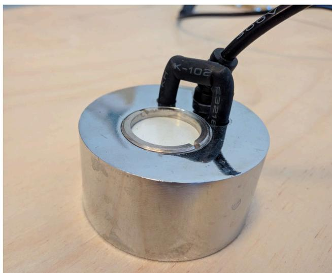
Рисунок 18 — Ультразвуковой распылитель
