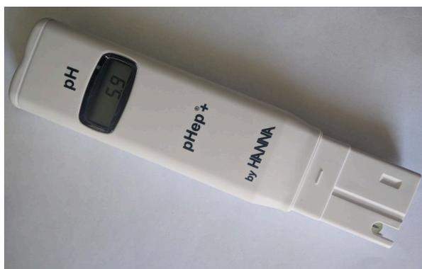
Рисунок 26 — Прибор для измерения pH жидкостей «pHep Tester»
