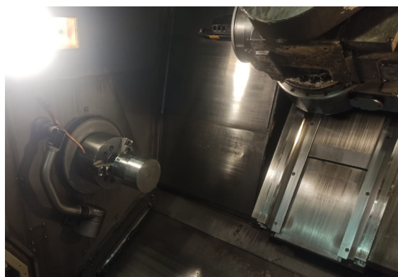
Рис. 3. Виды рабочей зоны станка с закрепленной заготовкой (а) и установленной оправкой (б) с керамической пластиной
