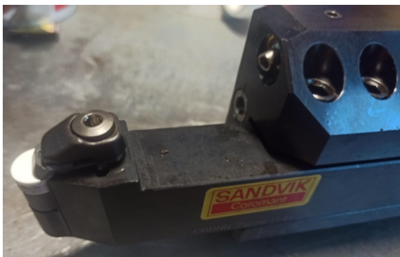
Рис. 2. Внешний вид оправки с закрепленной керамической пластиной
