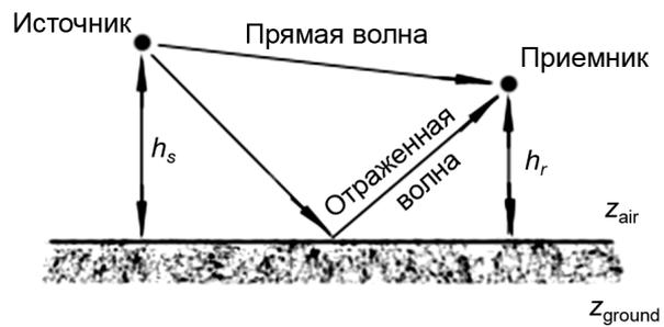
Рис. 1. Геометрия приземного распространения звука
