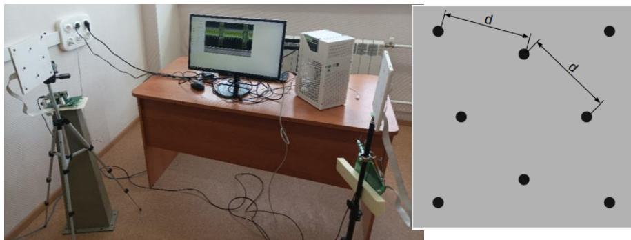
Рисунок 13 – а – Фотография экспериментальной установки, б – Размещение элементов в передающей и приемной решетках ( d = 80 мм)
