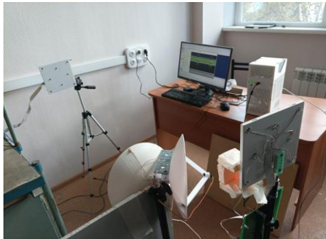
Рисунок 18 – Использование ретранслятора для обеспечения связи за преградами
