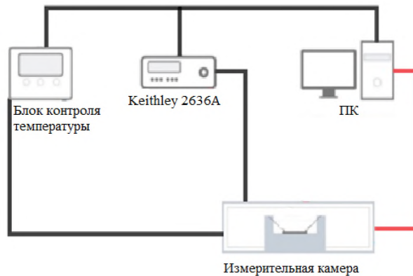
Рис.2 Схема измерительной установки для исследования ВАХ образцов
