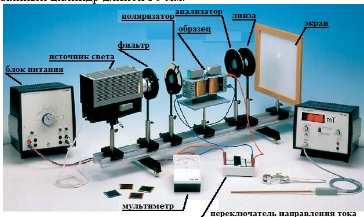
Рис. 3. Экспериментальная установка для изучения эффекта Фарадея
