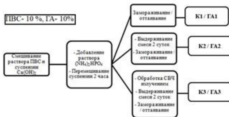
Рис 1. Схема получения композиционных материалов ГА-ПВС
