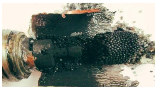
Рис. 2. Результат введения электроразрядной плазмы в гранулированный полиэтилен
