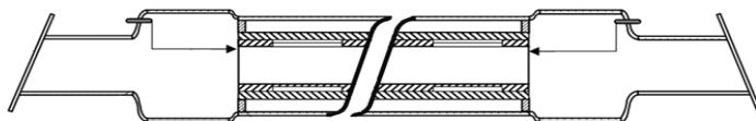
Рис. 1. Газоразрядный активный элемент на парах бария с изолированными полостями для металлического бария
