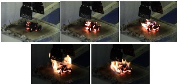
Рис. 4. Группа снимков по зажиганию частицами образца фанеры
