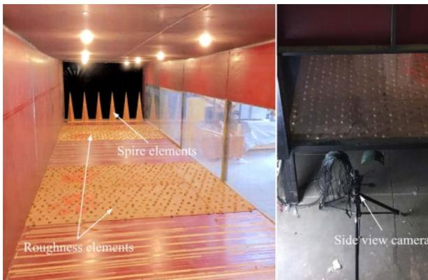
Рис. 1 Установка: (Слева) внутри камеры аэродинамической трубы, где установлены элементы шероховатой поверхности и элементы шпиля; (справа) положение камеры на вид сбоку показывает точку выпуска (расположение струи)[1]
