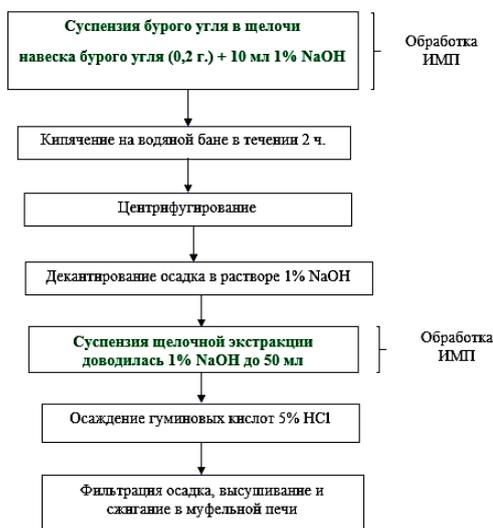
Рис. 1 Схема обработки ИМП суспензии бурого угля в щелочи и суспензии щелочной экстракции
