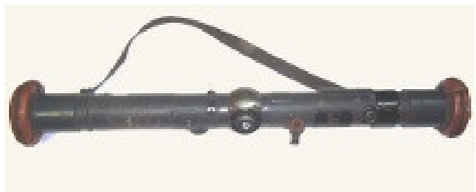
Рис. 11. Однометровый зенитный дальномер Entfernungsmesser 34 [13]
