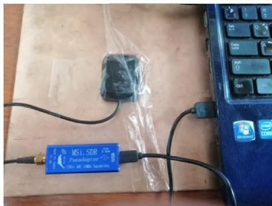
Рис. 2. GPS антенна и MSI.SDR Panadapter
